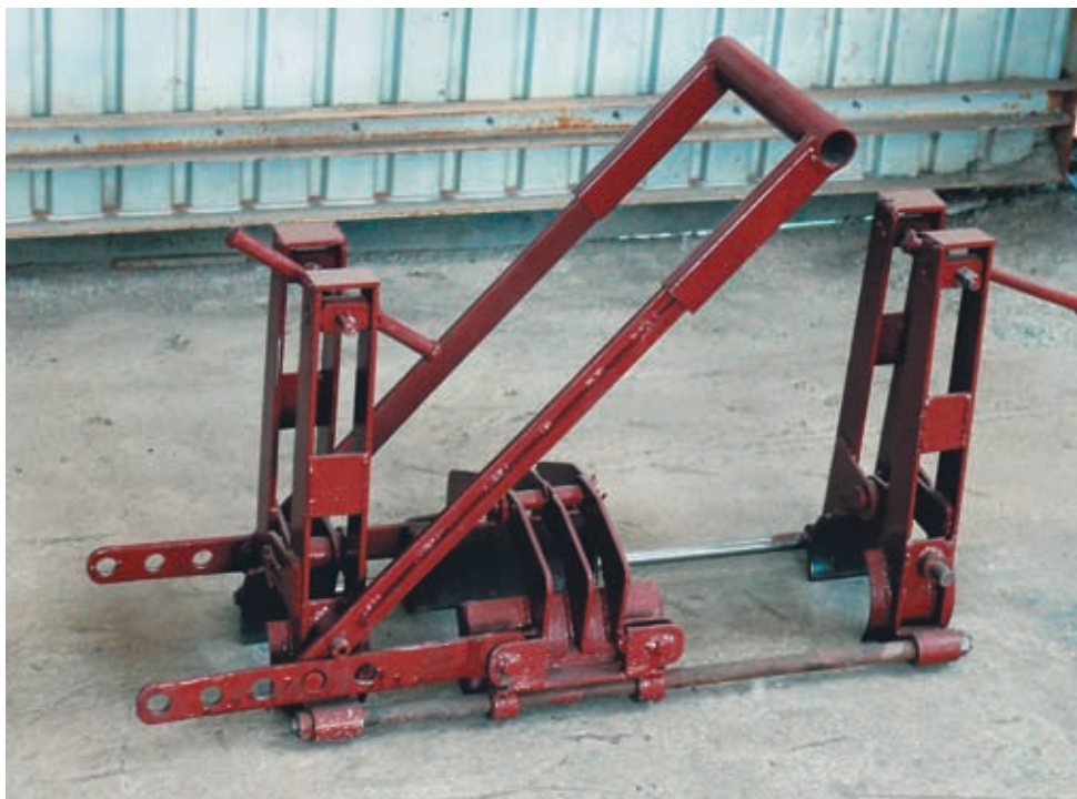
Рис. 4.26. Рычажное натяжное приспособление для монтажа/демонтажа муфты
