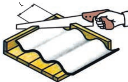
Рис. 2.19. Способы подрезки углов хризотилцементных листов: а) подрезка листа с помощью дисковой пилы; б) подрезка листа на деревянном шаблоне; L – величина продольной нахлестки листов
