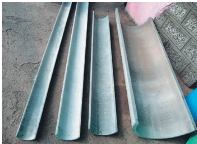
Рис. 4.39. Лотки из хризотилцементных труб
